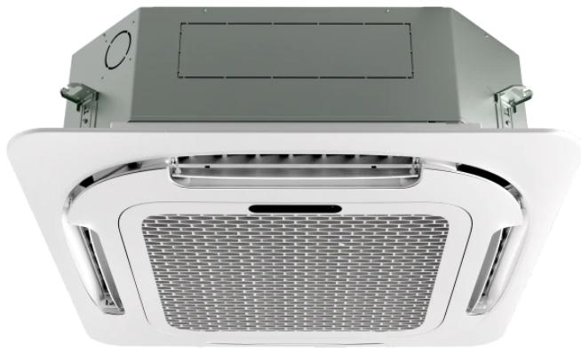
Die Multi Split 3,4kW R32 AURA line Kassetteneinheit ist ein spezialisiertes Heizsystem mit einer Nennleistung von 3,95 kW und einer Kühlleistung von 3,52 kW. Sie zeichnet sich durch die hohe Energieeffizienzklasse A++ für Kühlung und A+ für Heizung aus. Sie bietet Funktionen wie unabhängige Entfeuchtung oder schnelles Heizen bei -20°C. Das System sorgt für komfortable Bedingungen dank der I FEEL-Funktion und der Möglichkeit der Fernsteuerung über Wi-Fi.
