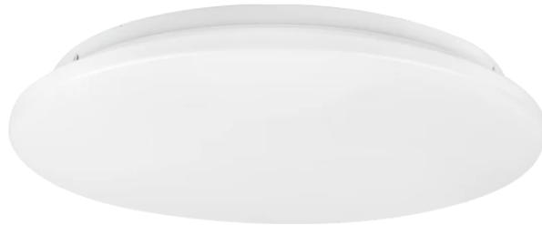
18W LITE LED Plate ist eine innovative Einstellung für exzellente Lichtqualität. Erzeugt einen Lichtstrom von 1550 lm, der eine effektive Beleuchtung mit einer Lichtleistung von 86 lm/W gewährleistet. Farbtemperatur 4000K bietet neutrales Licht, ideal für verschiedene Anwendungen. IP44 Leck-Klasse schützt vor Wasser und Staub und Ra >80 Farbwiedergabe ermöglicht eine treue Farbwiedergabe.
