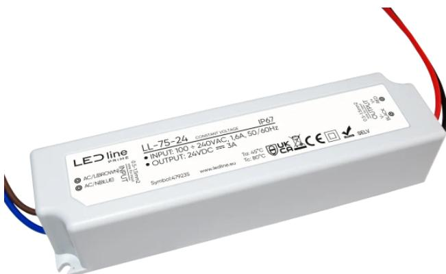
PRIME 75-24 IP67 LED-Leitungsnetzteil ist ein fortschrittliches Gerät mit einer Ausgangsleistung von 72 W, ausgelegt für LED-Systeme. Sie zeichnet sich durch einen breiten Bereich der Eingangsspannung von 90 bis 264 V AC und eine stabile Ausgangsspannung von 24 V aus. Seine Wirksamkeit beträgt 0,86 und der Leistungsfaktor PF 0,95. Das verwendete IP67-Leckstandsgehäuse sorgt für Beständigkeit gegen Wasser und Staub, wodurch es eine ideale Wahl für schwierige Betriebsbedingungen ist.
