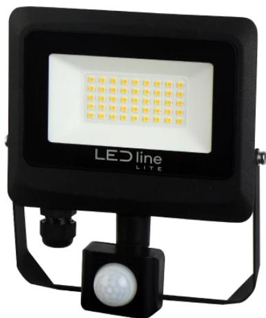
LITE PHOTON 30W 4000K LED-Leitung, die einen 3000 lm Lichtstrom emittiert, ist eine fortschrittliche Lösung mit hoher Energieeffizienz und erreicht 100 lm/W Lichteffizienz. Aus gegossenem Aluminium und gehärtetem Glas zeichnet es sich durch außergewöhnliche Haltbarkeit und Beständigkeit gegen widrige Witterungsbedingungen aus. Ausgestattet mit einem Bewegungssensor und einstellbarem Beleuchtungswinkel ermöglicht es eine optimale Raumbeleuchtung.
