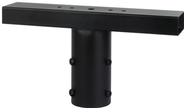
Der Leuchtenhalter für den Klapp-Beleuchtungspol ist für die Montage an Stöcken mit einem Durchmesser von 60 mm bestimmt, die eine direkte Montage der Lampe ermöglichen. Es hat einen Montagelochabstand von -7,5 cm bis +7,5 cm, so dass Vielseitigkeit bei Verwendung mit PRIME-Modellen mit einer maximalen Leistung von 200W. Die Montagebasisabmessungen sind 40x8 cm und bieten eine stabile und robuste Bauweise.
