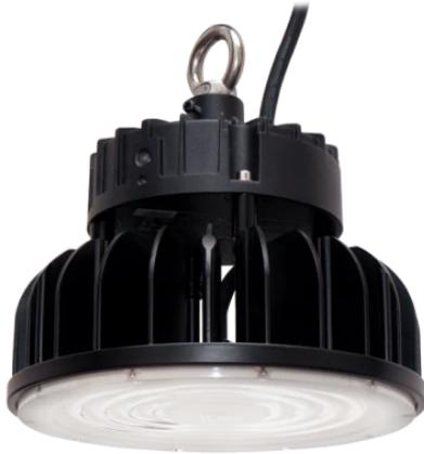
Eine 100 W UFO LED Leuchte emittiert ein neutrales Licht von 4000 K, wodurch eine Lichtleistung von 130 lm/W und ein Gesamtlichtstrom von 13000 lm erreicht wird. Hergestellt aus Aluminium und Polycarbonat, bietet es Haltbarkeit und Beständigkeit gegen atmosphärische Bedingungen, die IP65 Leck-Klasse bestätigt. SMD3030 Diode garantiert Zuverlässigkeit und die Haltbarkeit beträgt 50000 Stunden. Die Lampe hat einen weiten Winkel der Lichtverteilung (120°) und Energieeffizienzklasse E.
