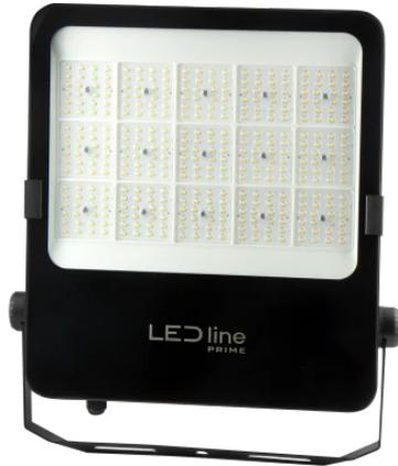
Die PRIME Floodlight 200W LED-Linie ist ein fortschrittliches Hochleistungs-Gerät, das einen Lichtstrom von 28000 Lumen erzeugt, die in eine Energieeffizienz von 140 lm/W übersetzt. IP66 Leck-Klasse bietet Beständigkeit gegen atmosphärische Bedingungen, und solide Aluminiumgehäuse garantiert Haltbarkeit und Langlebigkeit des Produktes. PF Leistungsfaktor 0.
