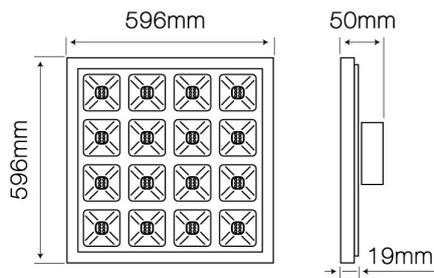
Das Panel hat eine Ausgangsleistung von 15-36 W und eine Farbtemperatur von 4000 K. Der Typ der Diode die im Produkt verwendet ist SMD2835. Das Produkt erzielt eine Lichtausbeute 150-140 lm/W. Das Produkt erzeugt einen Lichtstrom von 2250-5040 lm. Der Abstrahlwinkel der Dioden beträgt 75 °.
