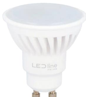
LED Lampe GU10 7W aus der LED Linie PRIME ist eine effektive Lichtquelle mit 1000 Lumen. Dank der Verwendung von SMD2835 Dioden erreicht es Leistung von 142 lm/W. Farbtemperatur 6500 K bietet neutrales weißes Licht. Mit Lichtwinkeln von 120° garantiert sie eine gleichmäßige Beleuchtung. Keramik Gehäuse erhöht Haltbarkeit und effiziente Wärmeableitung.
