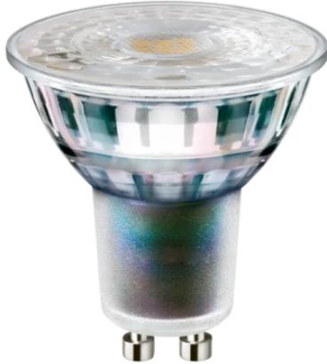
LITE GU10 5,5W 2700K LED-Line-Lampe ist eine effiziente Quelle von warm-Farb-Licht, die 500 Lumen emittiert. Seine Farbtemperatur beträgt 2700 K, die eine gemütliche Atmosphäre bietet. Stromversorgung durch 220-240 V Wechselfrequenz und 50/60 Hz-Frequenz, hat es eine hohe Energieeffizienz von 91 lm/W und eine Haltbarkeit von bis zu 30.000 Stunden. Dank der TRIAC-Funktion ist es möglich, sie bequem zu dimmern.
