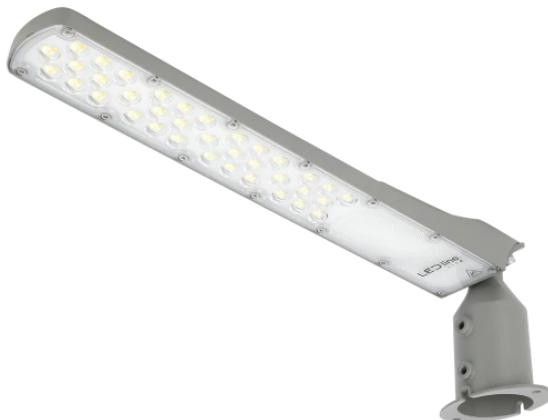
FLAMINGO 100W 4000 K Straßenleuchte zeichnet sich durch eine hohe Lichtleistung von 10000 lm und neutraler Lichtfarbe aus. Hergestellt aus Aluminiumguss, bietet Beständigkeit gegen atmosphärische Bedingungen (IP65) und mechanische Beschädigung (IK08). Der installierte Dämmerungssensor schaltet die Beleuchtung bei 50 lx automatisch ein und schaltet bei 500 lx aus.
