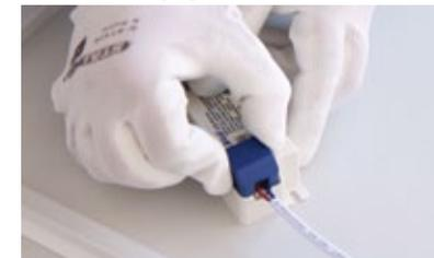
6. Drugi koniec przewodu (brązowego i niebieskiego) podłącz do sieci elektrycznej 230V/Connect the other ends of the brown and blue wires to the 230V mains power./L'autre finition du fil marron et bleu doit être connectée directement à 230V/Das andere Ende des braunen und des blauen Drahts muss direkt an 230V angeschlossen werden
