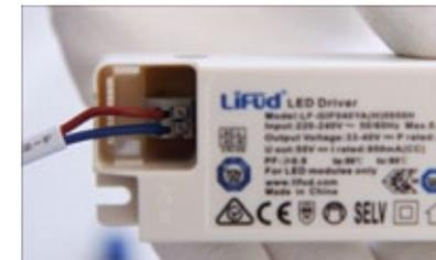
4. Przewód brązowy i niebieski dołączony do zestawu podłącz do wejścia zasilacza (AC IN)/Connect the brown wire and the blue wire to the LED driver's input channel (AC IN)/Connectez le fil marron et bleu au canal d'entrée du driver LED (AC IN)/Verbinden Sie den braunen und den blauen Draht, die im Set enthalten sind, mit dem Eingangskanal des Netzteils (AC IN)
