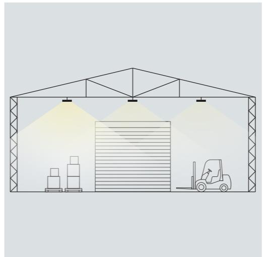
Die SERON-Leuchten sind mit einer dreistufigen Leistungsregelung (100 %, 80 %, 60 %) ausgestattet, die eine einfache Anpassung der Lichtintensität an die Anforderungen des jeweiligen Raums ermöglicht – ganz ohne Eingriffe in die Installation.
